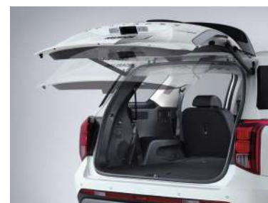
Система электропривода двери багажника автомобиля
